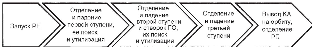
Рис. 2. Технологический цикл запуска РН «Протон-М»
